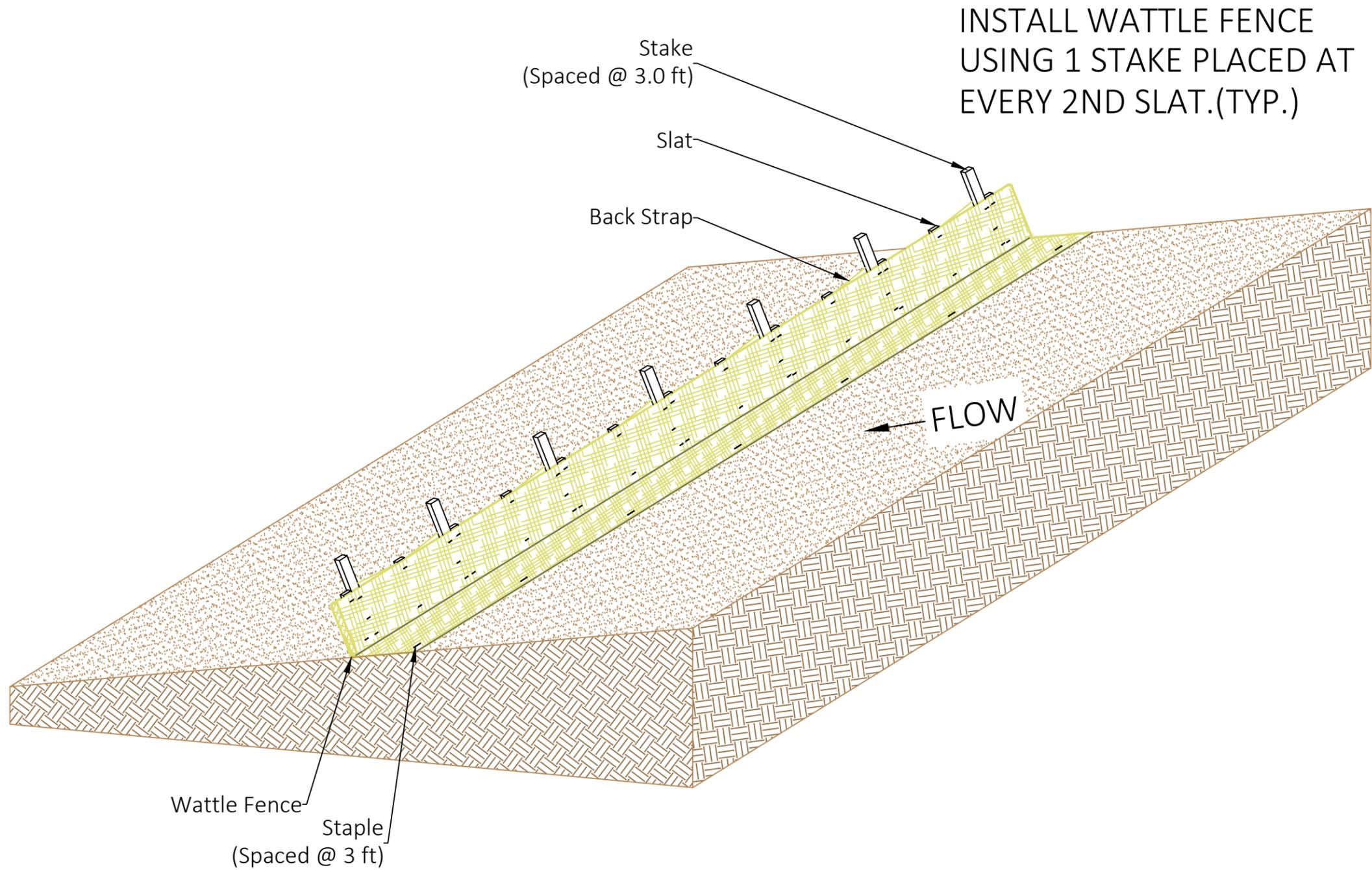
TYPICAL SLOPE INSTALLATION
